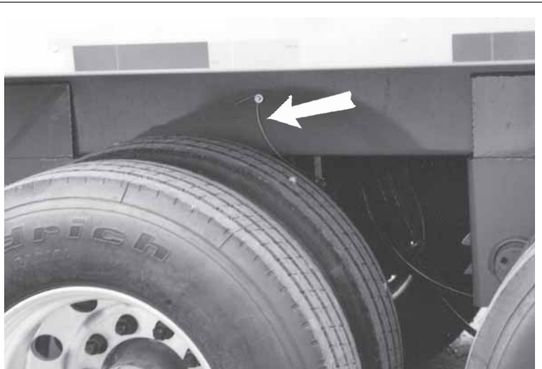
Purge de réservoir
